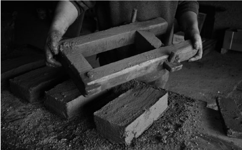
7. Fabrication d'un caïró ( cayrou )
