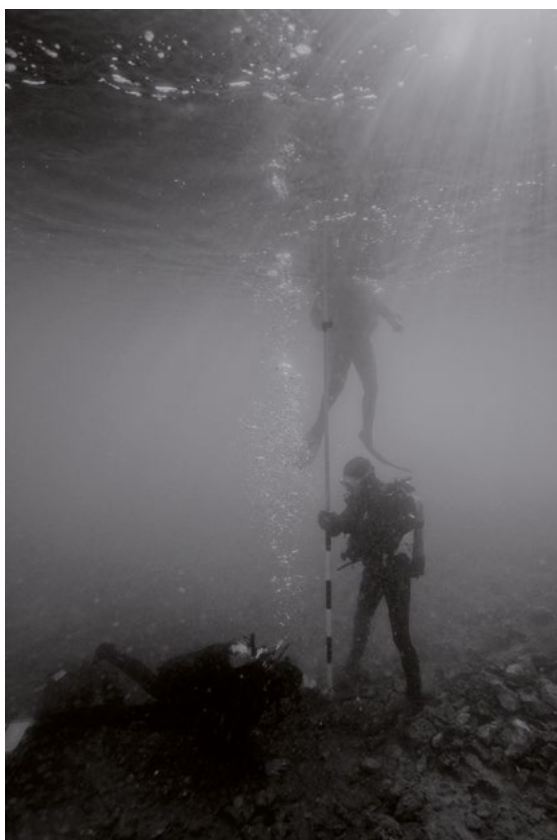
Fig. 6. Relevé topographique de l'épave Caska 2 : un opérateur assure le positionnement sur le fond de la canne qui est maintenue à la verticale et stabilisée par un second opérateur, tandis qu'un troisième, à la surface, réalise un croquis et garantit la communication avec la station de relevé à terre. Mission franco-croate : UniZd – CCJ. Cliché : Ph. Groscaux (CNRS-AMU, CC)
