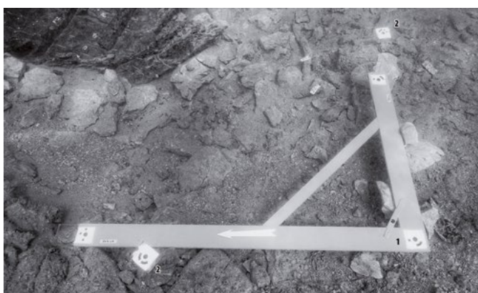
Fig. 7. Équerre métallique servant de système de référence local (1) et points d'appuis géoréférencés (2) utilisés pour le relevé photogrammétrique de l'épave Caska 2. Mission franco-croate : UniZd – CCJ. Cliché : Ph. Groscaux (CNRS-AMU, CC)
