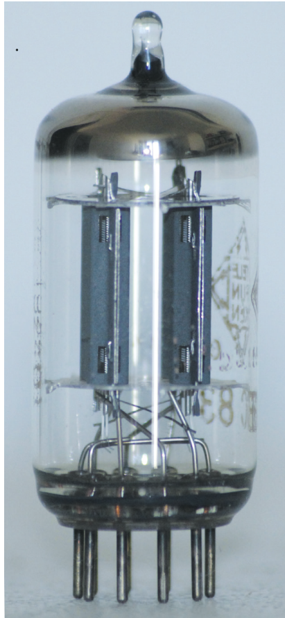
1. Plan rapproché d'une lampe ECC83/12AX7 Ce tube de préamplification contient 2 triodes, dont nous voyons ici les anodes.
