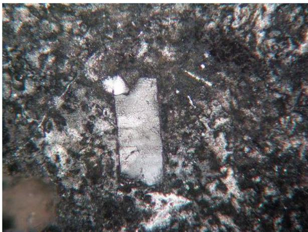
Fig. 534. Quelques rares phénocristaux de sanidine sont observés en LPA x80
