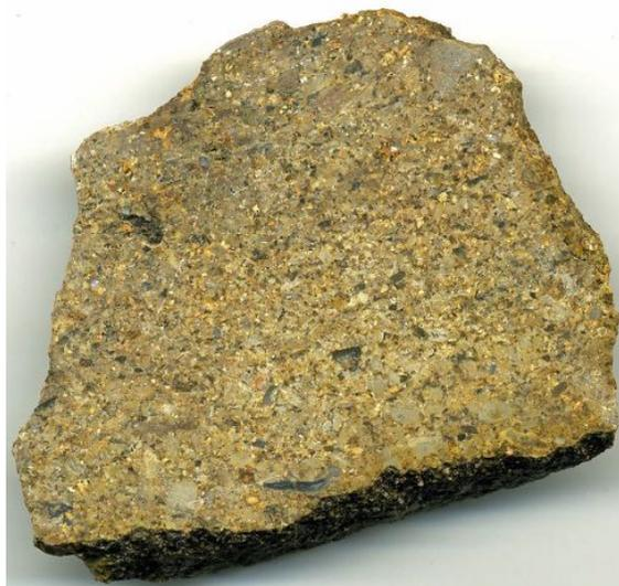
Fig. 484. Coupe polie d'un échantillon de l'arkose exploitée dans la carrière sud
