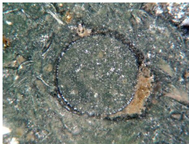
Fig. 524. Vue en LPA x200 d'une bille de verre remplie de microlithes (photo : F. Gendron/MNHM)
