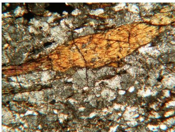
Fig. 386. Porphyroclaste de hornblende étiré et déformé vu en LPA x40. L'étirement a provoqué une ouverture des clivages
