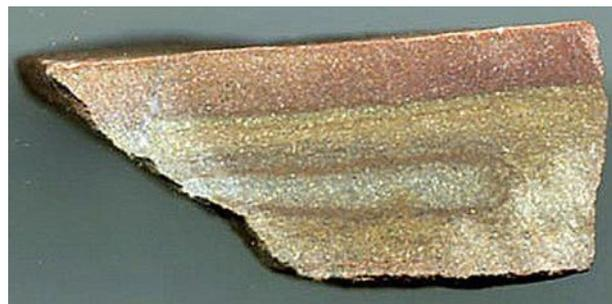
Fig. 458. Moellon de grès rubané à ciment calcaire MA-Mo8, *cala* 23
