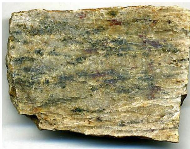
Fig. 317. Coupe polie du moellon de leptynite MA-Mo<sub>4</sub>, *cala 21*, la roche est leucocrate et la structure litée
