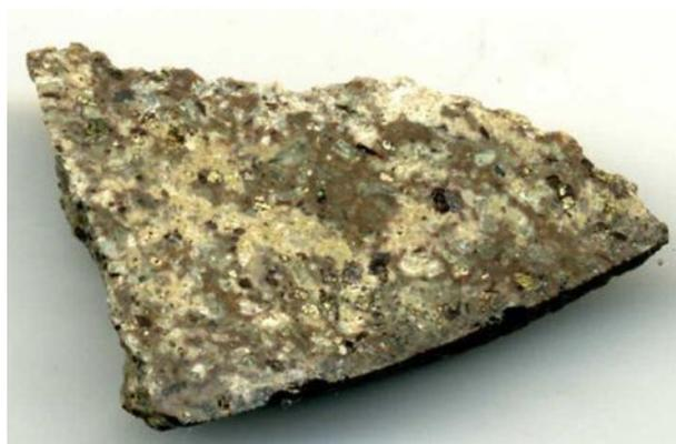
Fig. 605. Coupe polie du *mano* MA-Ou09. La structure microlithique de cette roche leucocrate est riche en phénocristaux blancs (feldspath) et noirs (amphiboles)
