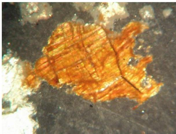
Fig. 551. Mica muscovite dans l'enduit de stuc du mur sud de la *cala* 38 vu en LPA x20
