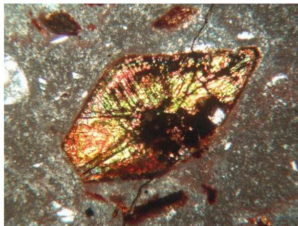
Fig. 599. Phénocrystal d'augite automorphe pris dans un verre gris chargé de microlithes vu en LPA x40. Les clivages suborthogonaux sont très nets
