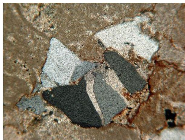
Fig. 434. Grain de quartz tectonisé pris dans la matrice calcaire, vu en LPA x40
