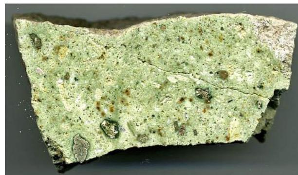
Fig. 507. Coupe polie du moellon d'ignimbrite MA-M19a (Tombe 240). On observe des morceaux de ponce pris dans la matrice verte et quelques oxydes
