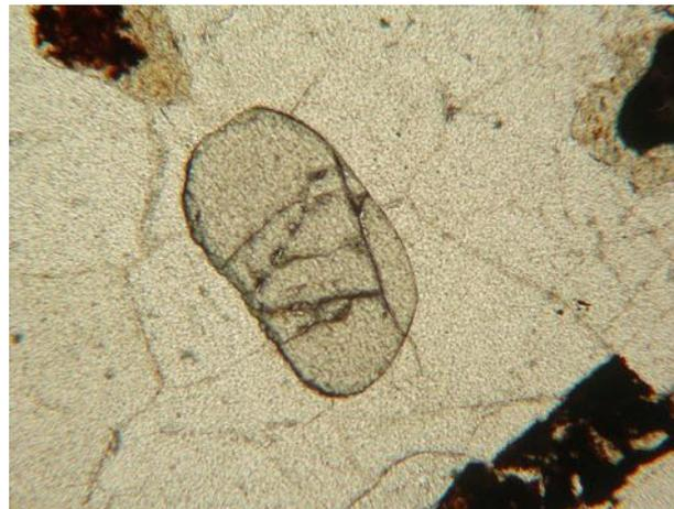
Fig. 453. Grain très émousé d'amphibole identifiable à sa couleur verte vu en LPNA x200
