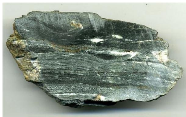
Fig. 411. Coupe polie du galet de schiste mylonitique PNV-01
