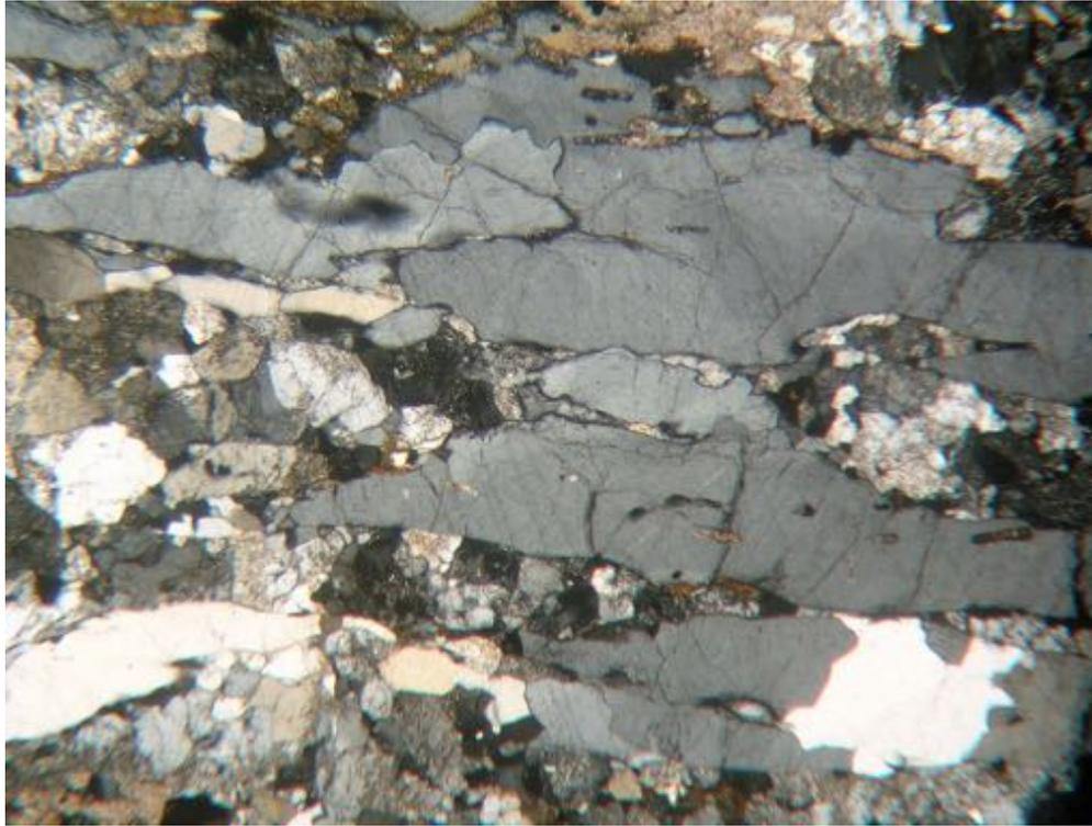
Fig. 696. Lits de quartz tectonisés entre des lits de plagioclases, de feldspaths et de muscovite vus en LPA x6
