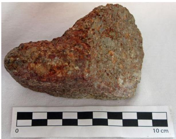
Fig. 431. Moellon de litharénite MA-Mo<sub>3</sub>, sa couleur rouge est due à une imprégnation d'oxyde de fer
