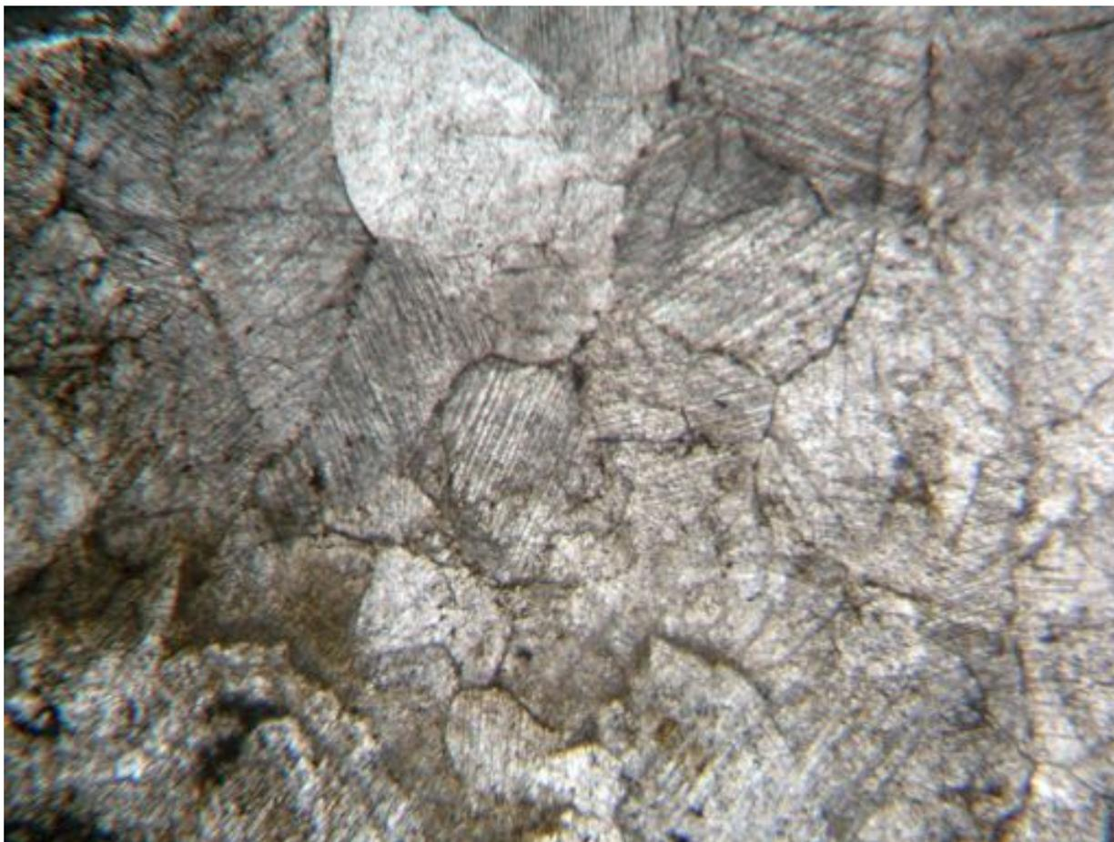
Fig. 569. Morceau de calcite maclée dans l'enduit du stuc de sol du niveau 2 de la *cala* 3 vu en LPA x20
