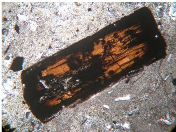
Fig. 598. Phénocrystal automorphe de biotite vu en LPNA x40. Il est pris dans un verre gris chargé en microlithes et sa périphérie est opaque car il est entouré par des oxydes opaques
