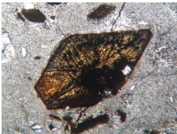
Fig. 600. Phénocrystal d'augite pris dans un verre gris chargé de microlithes vu en LPNA x40. Les clivages suborthogonaux sont très nets mais le centre du cristal est corrodé
