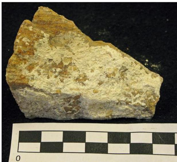
Fig. 316. Moellon de leptynite MA-Mo<sub>4</sub>, *cala 21*, on aperçoit sur la gauche la structure litée sous la couche de stuc
