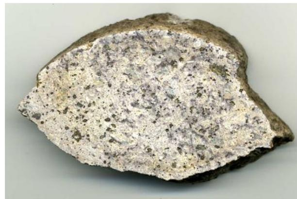
Fig. 618. Coupe polie du *mano* MA-Ou12. La structure microlithique de cette roche ignée leucocrate est très riche en phénocristaux de feldspath et noirs d'amphiboles
