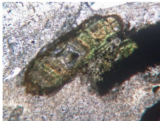
Fig. 613. Phénocrystal d'amphibole subautomorphe pris dans un verre gris chargé de microlithes vu en LPNA x80
