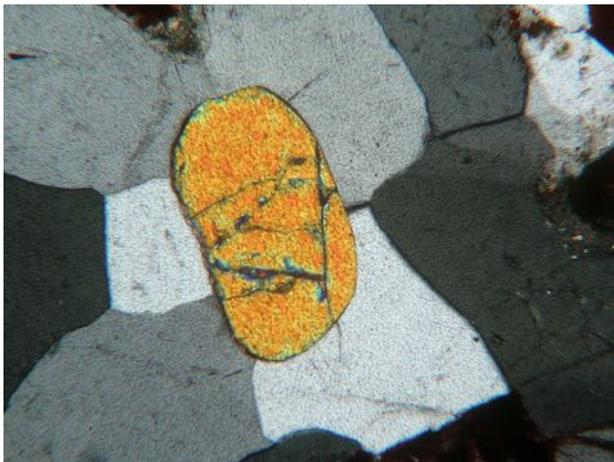
Fig. 452. Grain très émousé d'amphibole clivée à  $120^\circ$  vu en LPA x200
