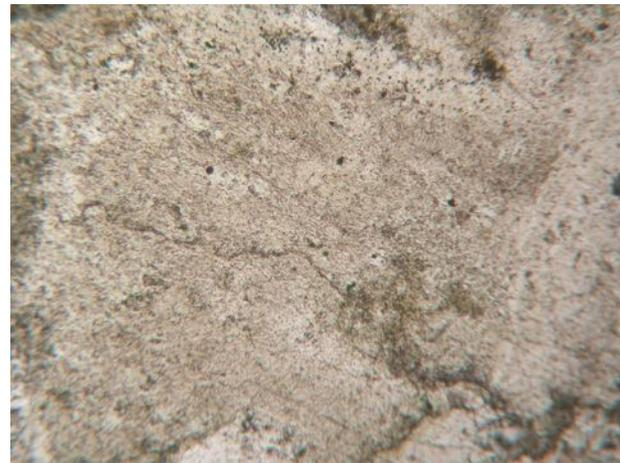
Fig. 533. En LPNA x40 le sphérolite est guère visible car son relief optique se confond avec les fond vitreux qui l'entoure
