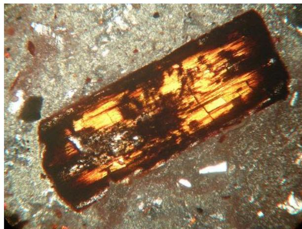
Fig. 597. Phénocrystal de biotite automorphe vu en LPA x40. Les clivages peuvent être observés parallèlement à l'allongement du cristal et correspondent à sa couleur d'absorption maximum
