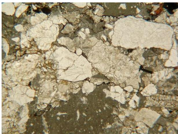
Fig. 419. Matrice clastique vue en LPNA x6, la différence de relief optique permet de distinguer les morceaux de roches sédimentaires (zones beiges) des minéraux quartzo-feldspathiques. Des cristaux d'oxydes opaques sont dispersés dans la matrice
