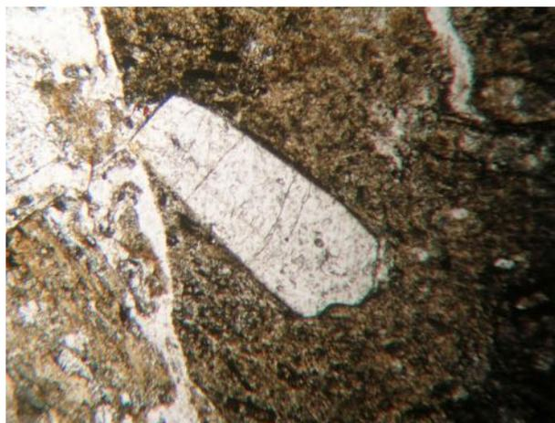
Fig. 642. Phénocrystal subautomorphe de quartz vu en LPNA x40
