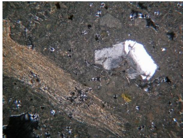
Fig. 509. Structure hypocrystalline vue en LPA x6. Au centre, le plagioclase présente une zonation normale continue due à une variation du chimisme entre l'intérieur et l'extérieur du solide. La lamine de verre située en dessous a un alignement régulier
