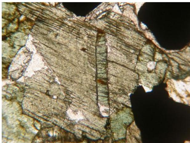
Fig. 276. Exsolution de clinopyroxène recoupée selon  $p$  (110) et incluse dans un orthopyroxène subautomorphe, vue en LPNA x40
