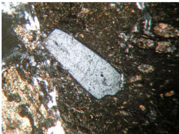
Fig. 641. Phénocrystal subautomorphe de quartz vu en LPA x40
