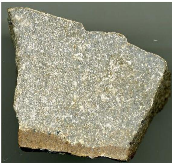
Fig. 480. Coupe polie d'un échantillon de l'arkose exploitée dans la carrière occidentale
