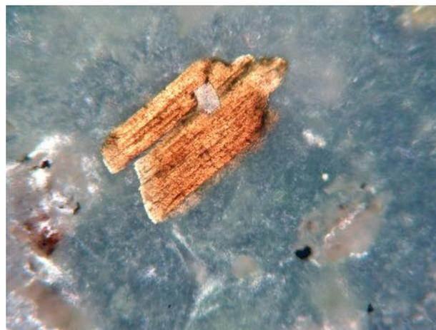
Fig. 522. Cristal de biotite vu en LPA x200, les clivages selon p (001) sont nets (photo : F. Gendron/MNHM)
