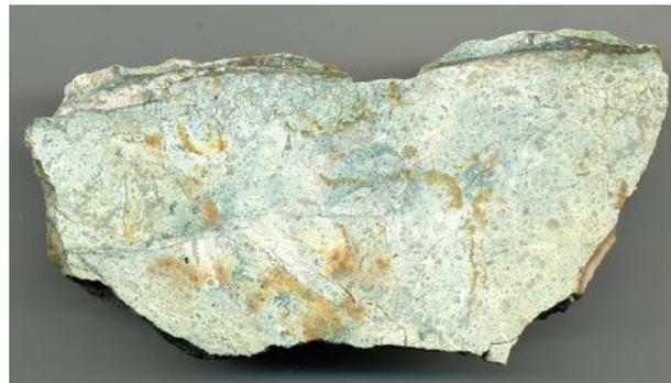
Fig. 527. Face polie d'un échantillon d'ignimbrite (SALJ-01) de la carrière de San Agustín de Las Juntas (photo : F. Gendron/MNHM)
