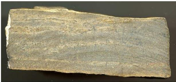
Fig. 494. Coupe polie d'un échantillon de dalle de calcaire exploité dans la carrière orientale 2, ép. : 32 mm
