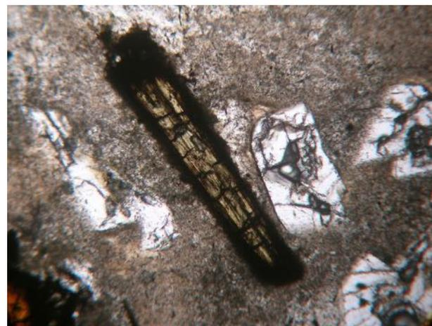
Fig. 615. Phénocrystal automorphe de biotite vu en LPNA x40 pris dans un verre gris brun chargé en microlithes. Sa périphérie est opaque car il est entouré par des oxydes
