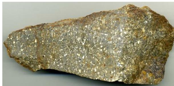
Fig. 479. Coupe polie d'un échantillon de l'arkose exploitée dans la carrière occidentale
