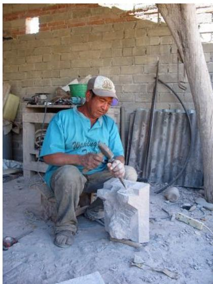
Fig. 661. Noe Martín Noriega Carenza, metatero de San Juan Teitipac taillant un *metate* tripode. Son outillage mêle des outils mécaniques et électriques
