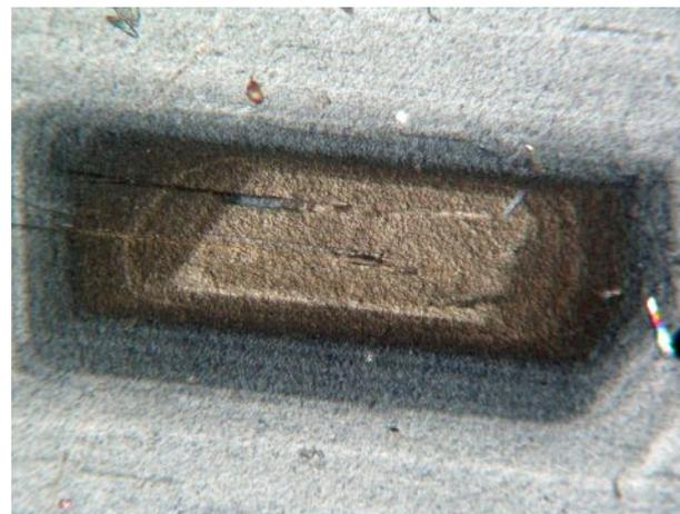
Fig. 520. Vue (agrandie) en LPA x40 de la zonation normale continue du plagioclase de la figure précédente
