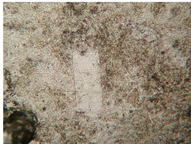
Fig. 535. En LPNA x80 ce phénocristal de sanidine se détache plus nettement que les quartz et les sphérolites de plagioclase sur le fond vitreux
