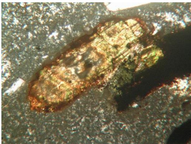
Fig. 612. Phénocrystal d'amphibole subautomorphe pris dans un verre chargé de microlithes vu en LPA x80
