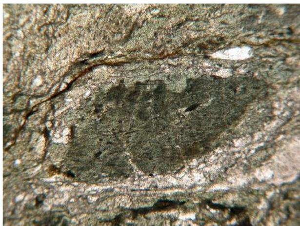
Fig. 356. Ce porphyroclaste de hornblende subsiste bien que sa périphérie soit très fracturée vu en LPNA x40
