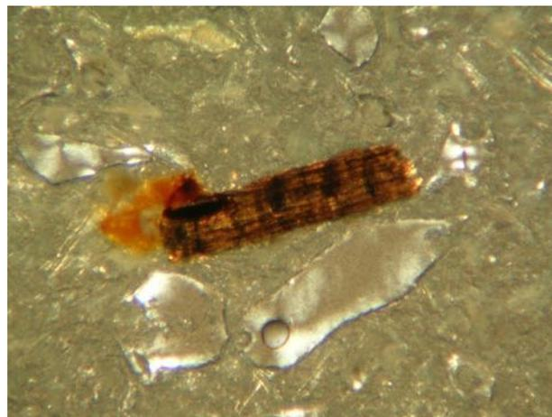
Fig. 511. Cristal de biotite vu en LPA  $\times 40$ , les clivages selon p (001)
