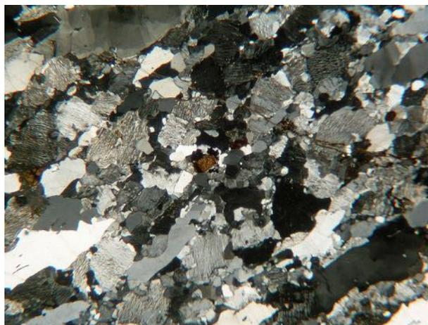
Fig. 318. Structure granoblastique vue en LPA x6. Les minéraux quartzo-feldspathiques constituent plus de 95 % de l'assemblage
