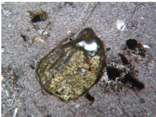
Fig. 602. Phénocrystal d'amphibole xénomorphe pris dans un verre gris chargé de microlithes vu en LPNA  $\times 40$
