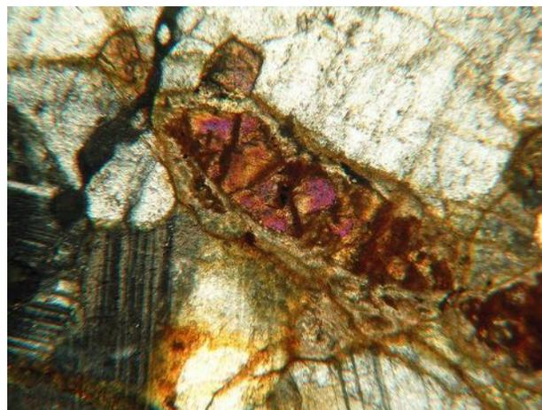
Fig. 311. Phénoblaste de clinopyroxène entouré par une frange réactionnelle microcristalline de phases hydratées (probablement à talc et anthophyllite) vue en LPA x200
