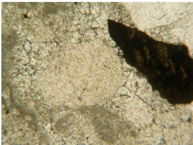
Fig. 421. Plagioclase xénomorphe (à gauche) et biotite (à droite) pris dans une matrice calcaire vus en LPNA x40
