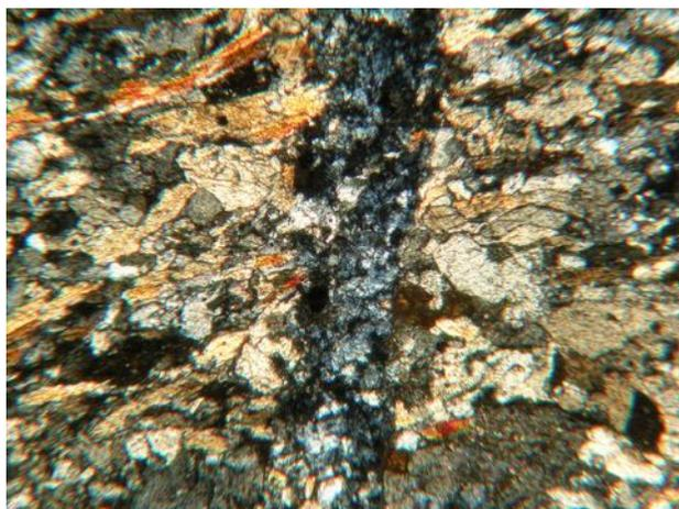
Fig. 401. Filonnet de quartz microcristallin recoupant perpendiculairement le litage vu en LPA x40
