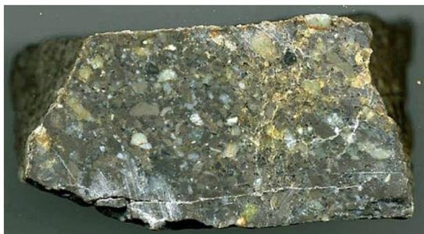
Fig. 417. Coupe polie du moellon d'arkose grise MA-Mo6, la matrice clastique n'est pas altérée et le sédiment est immature. C'est-à-dire qu'il s'agit d'un sédiment formé de grains de minéraux instables tels que feldspaths et fragments rocheux
