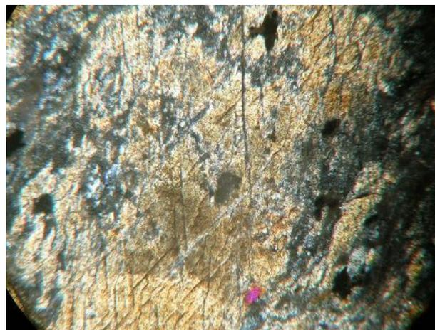
Fig. 359. Vue en LPA x200 du porphyroclaste de hornblende avec clivage à  $120^\circ$
