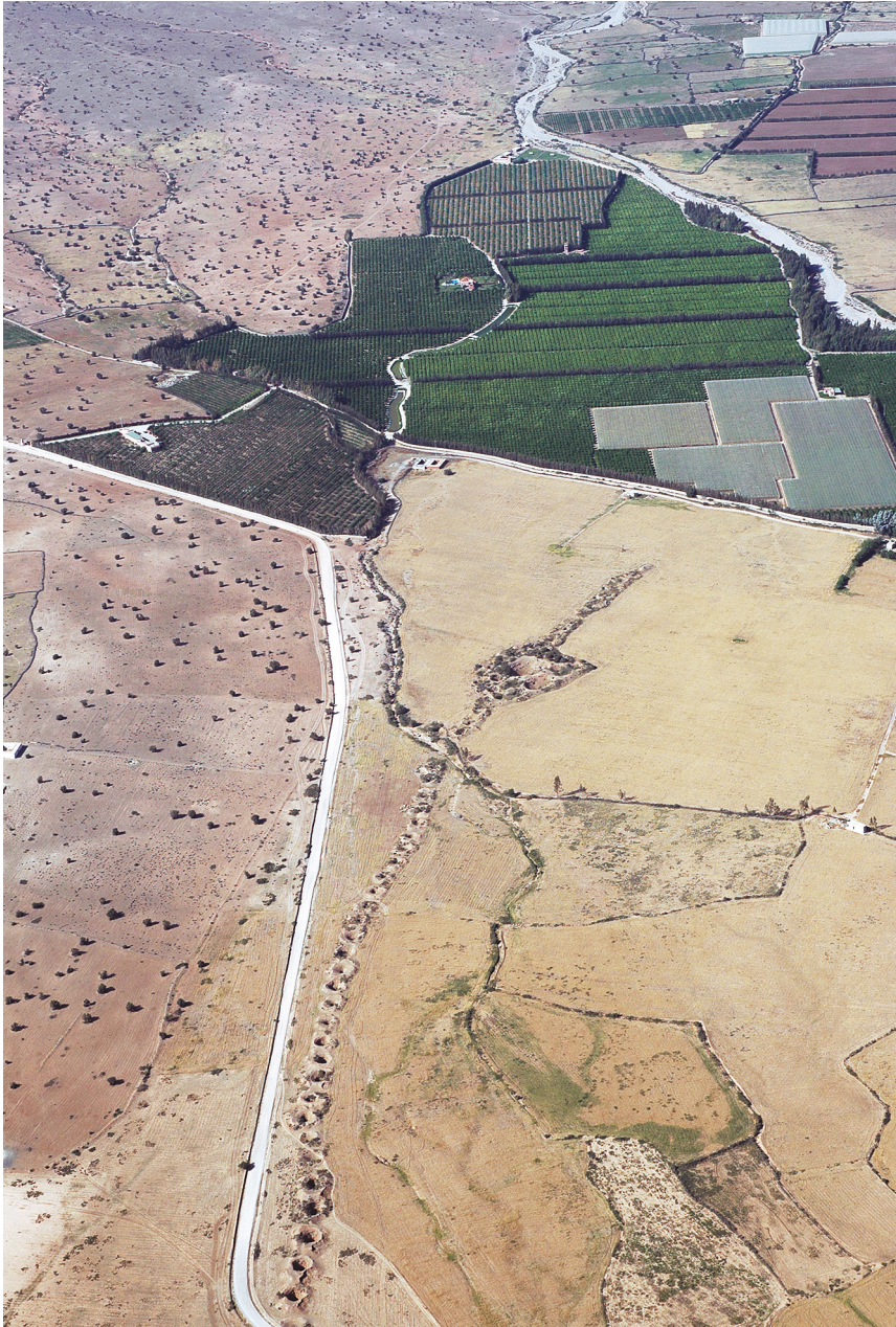
4. Galerie drainante morte sur le piémont méridional du Haut-Atlas marocain, avril 2005 Cette khattara est entrée, il y a peu, dans la catégorie des fossiles hydrauliques. Elle a, en effet, été stérilisée, définitivement très probablement, par la ferme d'agrumes qui la domine et dont les stations de pompage ont provoqué le rabattement de la nappe qui l'alimentait. Elle restera présente dans le paysage, pour un temps plus ou moins long, grâce à l'alignement des cônes de déblais qui entourent les puits qui n'ont servi qu'à sa construction et à son entretien périodique.
