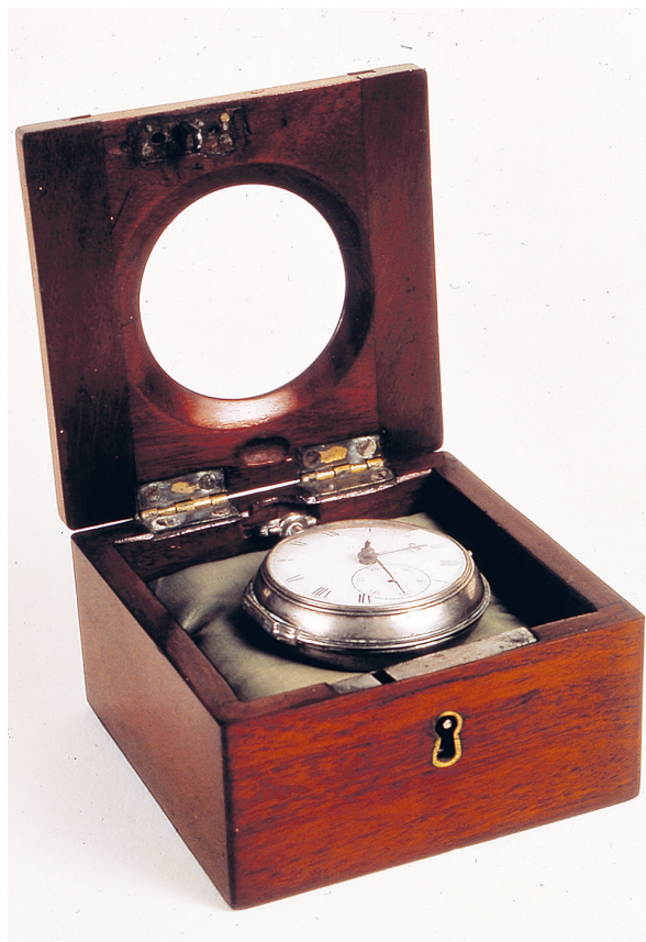
32. Horloge de poche pour déterminer la longitude (c. 1788)
